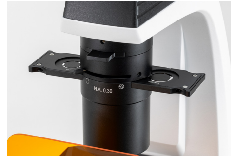
N.A. 0,3 Abbe Kondensator mit Phasenkontrastschieber
